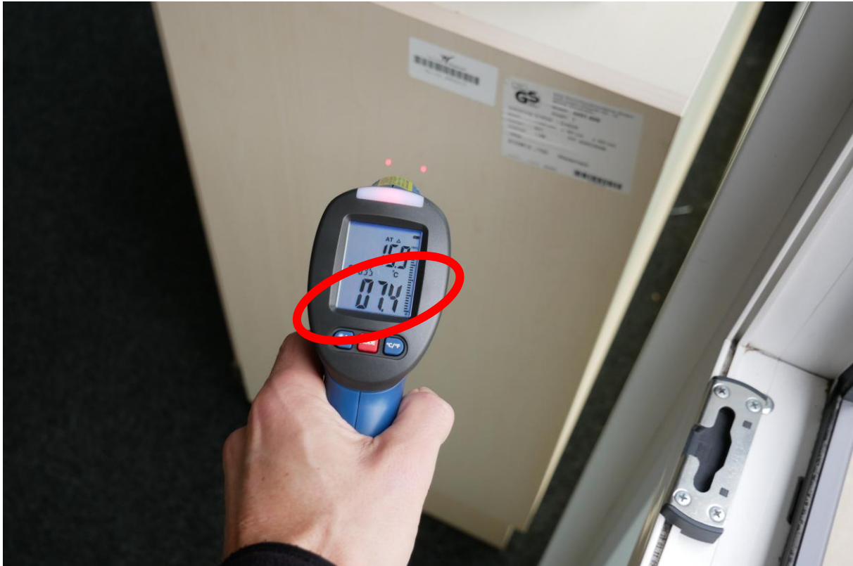
Dienstag, 20.10.2020 – 11:13 Uhr Oberflächentemperaturmessung (7,4 °C) durch das Fenster am Regal
